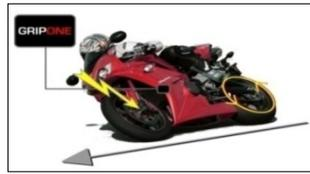
Quando viene rilevato un pattinamento superiore alla norma, la centralina provvede a ridurre la potenza del motore fino a che la motricità del veicolo non viene ripristinata. Una volta che il pneumatico posteriore ritrova la corretta aderenza e il pattinamento non ritorna entro la soglia accettata, la centralina cessa di ridurre la potenza.
