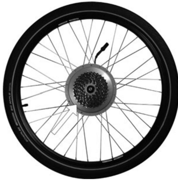
Il motore è alloggiato nel mozzo posteriore ed è alimentato da un pacco accumulatore. Il mozzo comprende un mozzo libero e una cassetta.
