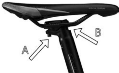
1. Allentate di alcuni giri la vite di arresto A fino a quando la sella si sposta facilmente e/o è possibile regolare l'inclinazione.
