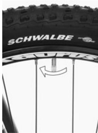
2. Controllate la pressione con un apposito misuratore per pneumatici presso un distributore di benzina, oppure con una pompa dotata di manometro.
