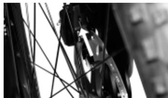
5. Abbassate con cautela la forcella fino a quando l'asse si trova a livello dell'arresto delle estremità a sinistra e a destra.
