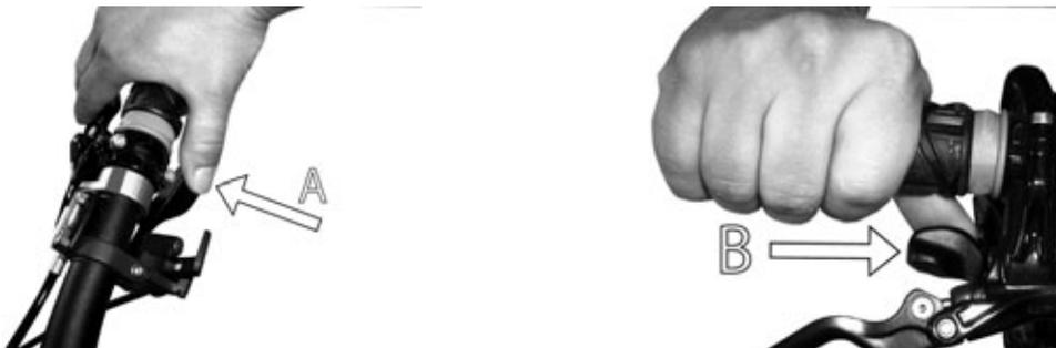
La leva di sinistra aziona il deragliatore. Qui il passaggio a una corona più grande comporta una moltiplicazione maggiore (= rapporto più alto). La resistenza alla pedalata aumenta, ma in questo modo è possibile ottenere una velocità più elevata.
