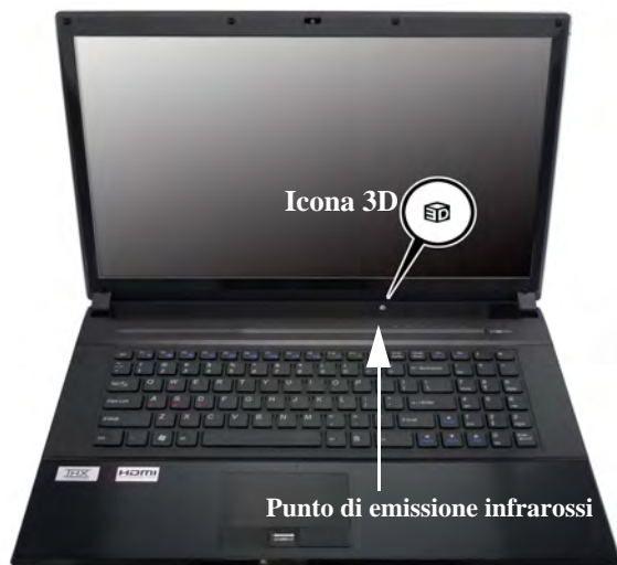
Figura 10 - Punto di emissione infrarossi
