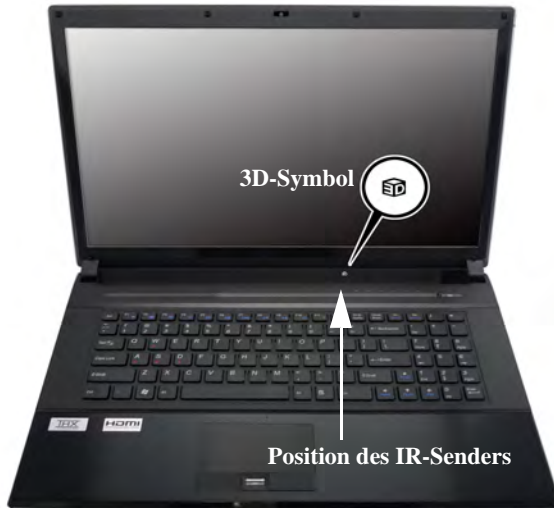
Abb. 10 - Position des IR-Senders
