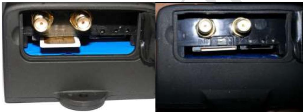
Spostare il tastino interno di selezione antenna verso la dicitura INT per utilizzare l'antenna GPS integrata oppure verso la scritta EXT per utilizzare l'antenna esterna GPS
