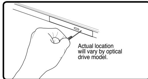
Il foro per l'apertura di emergenza si trova sull'unità ottica e viene utilizzato per far fuoriuscire il vassoio del drive ottico qualora l'apertura elettronica non funzionasse. Non utilizzare l'espulsione d'emergenza al posto di quella elettronica. **Nota: fate attenzione a non confondere la spia dell'indicatore di attività che si trova nella stessa zona.**
