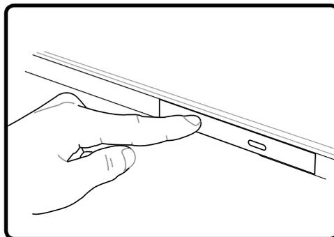
4. Premere con cautela il vassoio del drive all'interno. Il drive inizierà la lettura della TOC (table of contents) presente sul disco. Quando il disco si ferma è pronto per essere utilizzato.
