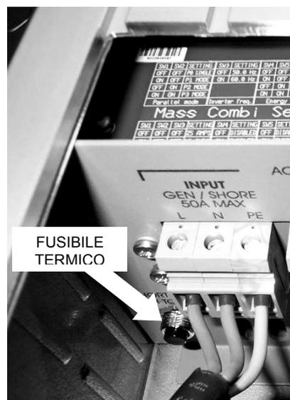
Figura 12: ripristino del fusibile termico
