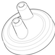
1. Per collocare l'adattatore di flusso nell'unità, farlo scivolare sul sensore nella parte frontale dello strumento, fino a bloccarlo saldamente.
