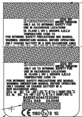
2. Questo dispositivo può essere utilizzato nelle Zone 1 e 2 per le versioni per gas infiammabili e nelle Zone 0, 1 e 2 per le versioni per ossigeno e gas tossici, per i gruppi di gas e vapori IIA, IIB e IIC nelle classi di temperatura T1, T2, T3 e T4
