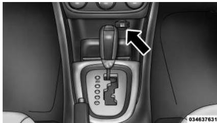
**Presa di corrente della plancia portastrumenti**
