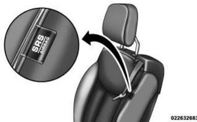
Etichetta dell'airbag supplementare laterale montato sul sedile
