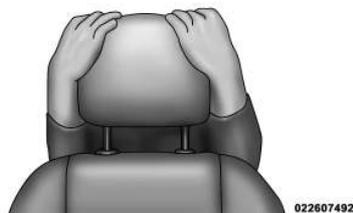
Punti di posizionamento delle mani sul sistema AHR
