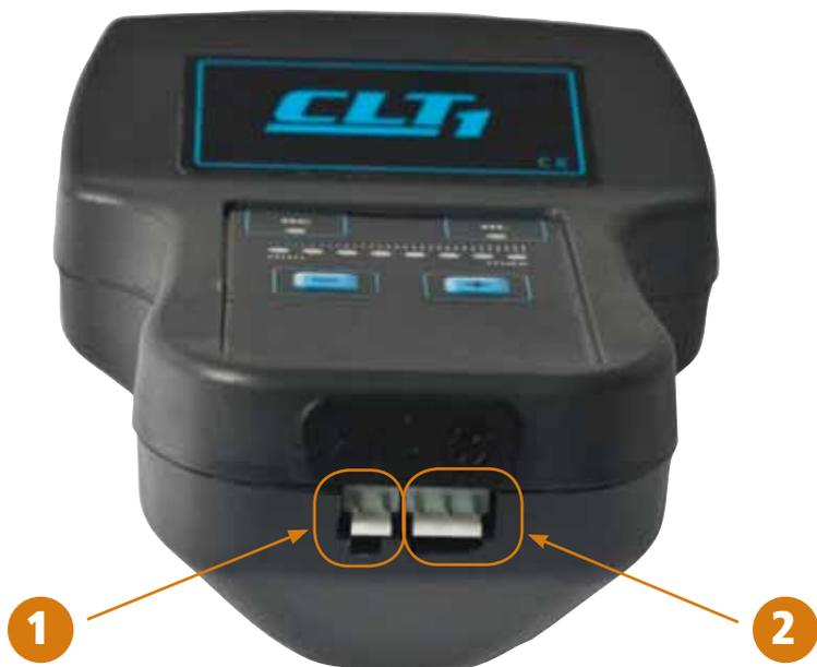
1. Porta con presa a 2 pin per il cablaggio della valvola di controllo del compressore.
