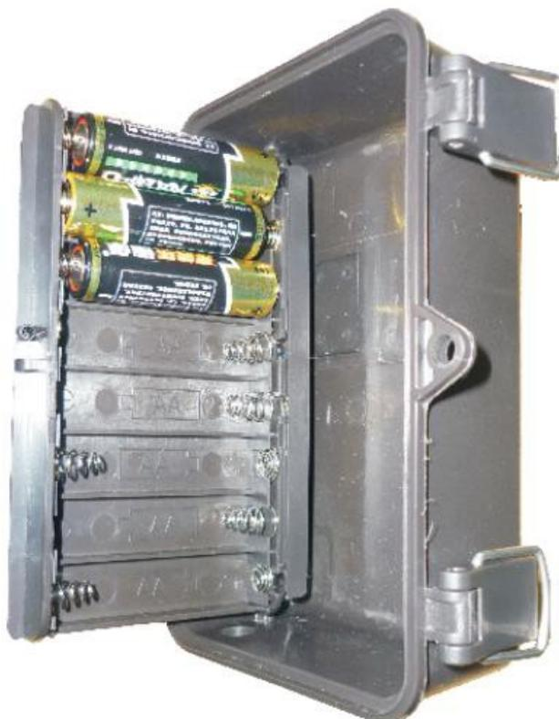
Si raccomanda l'utilizzo di otto nuove batterie al litio AA o alcaline AA oppure batterie ricaricabili NiMh. Utilizzando un alimentatore esterno (non fornito), è possibile collegare una fonte di alimentazione 6 Vcc al connettore "DC IN".
