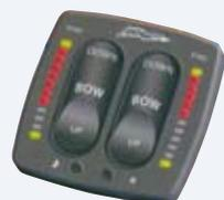
**54.10850** Pannello indicatore d'assetto a led luminosi ad intensità variabile per il giorno e la notte provvisto di autochiusura dei flap per singola stazione. E' sufficiente disinserire la chiave di accensione ed automaticamente le tavole tornano nella posizione di riposo. Completamente stagno. Alim. 12V. Dim. mm. 70 x 70
