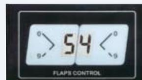
**54.54824** Pannello display LCD indicante l'angolazione flaps in 2 scale raffigurate in cifre variabili da 0 a 9. Display retroilluminato colore verde. Alim. 12/24 V. Dim. mm. 85 x 50
