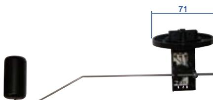
**54.54102** Sensore a leva 10-180 ohm, per serbatoi carburante regolabile da mm. 145 a 400. Per indicatori art. 54.54534/634/734.
