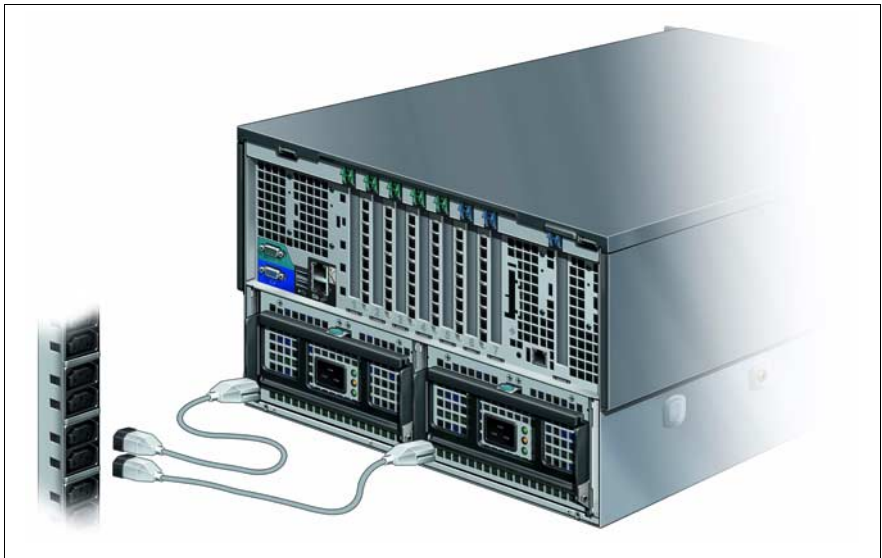
Immagine 17: collegamento del server alla rete (modello rack, modello floorstand analogo)
