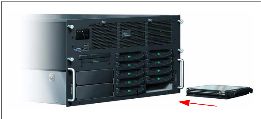
Immagine 32: installazione del modulo HDD
