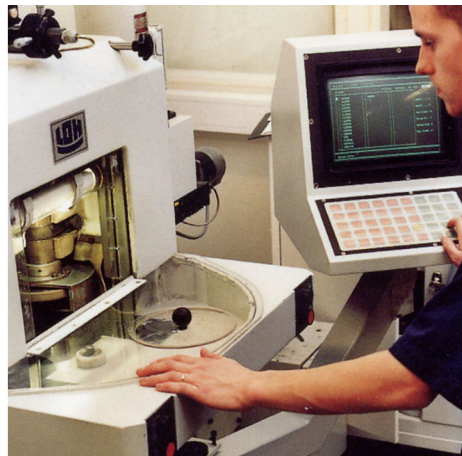
Figura 14.3 SINISTRA: tornio a punta di diamante; DESTRA: lucidatura dell'obiettivo
