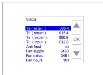
**Visualizzazione menu Stato con velocità ventilatori**
