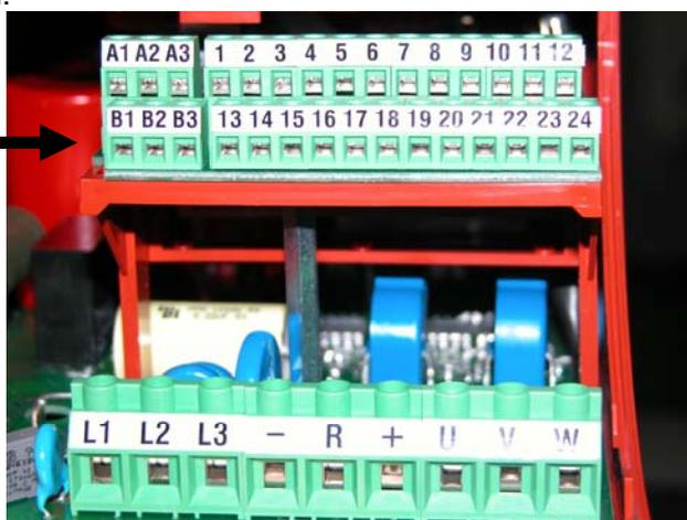
Figura 5.1-1: Accesso ai morsetti di regolazione e potenza
