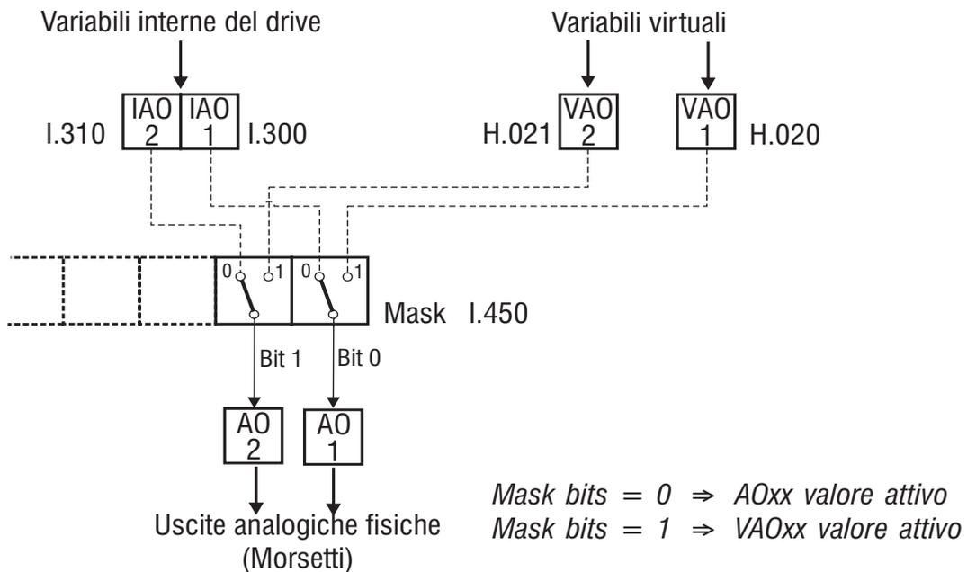
Figura 1.1-7: Configurazione uscite analogiche virtuali
