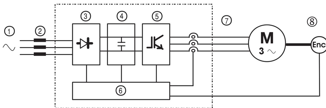
Figura 3.2-1: Schema fondamentale di un inverter di frequenza
