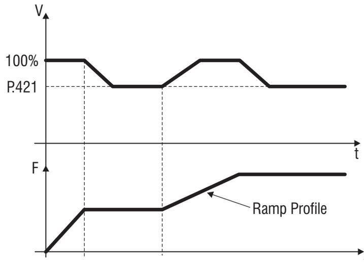
Figura 1.1-20: Riduzione della tensione d'uscita con P.420 = 1
