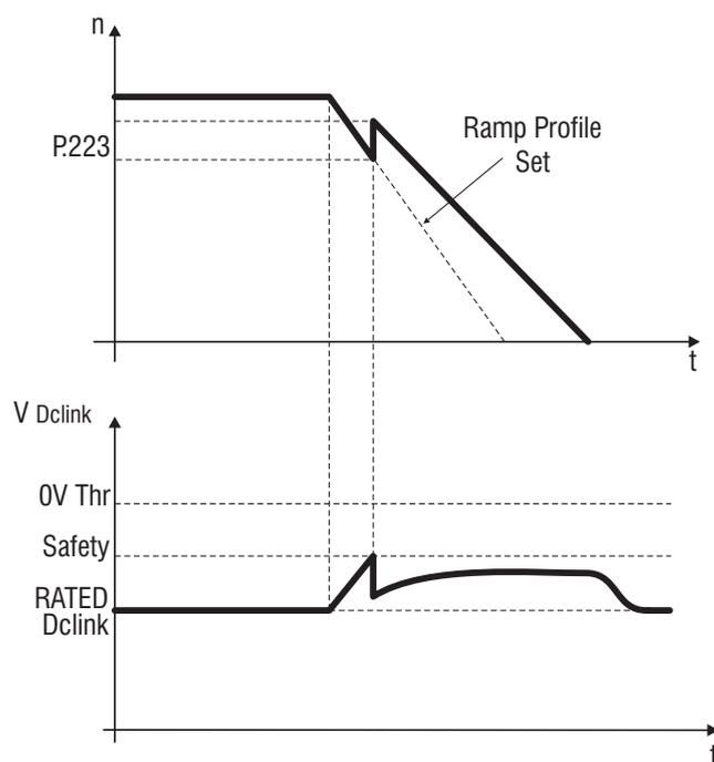
Figura 1.1-14: Controllo della tensione del DC Link
