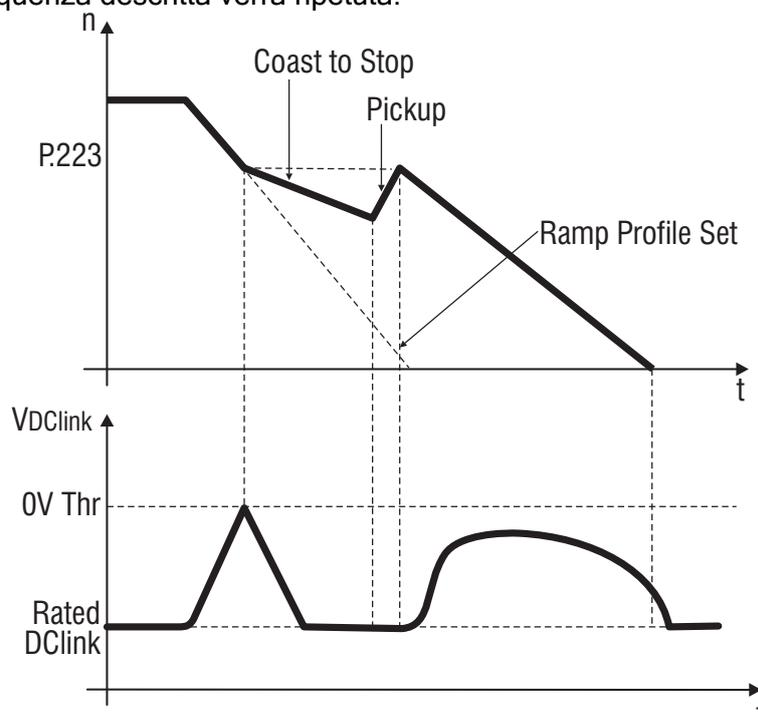
Figura 1.1-18: Prevenzione dell'allarme di "Sovratensione"
