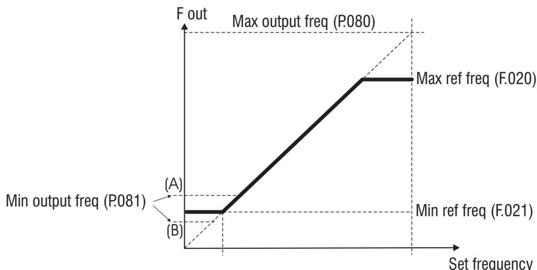
Figura 1.1-11: Minimi e Massimi del Riferimento di Frequenza
