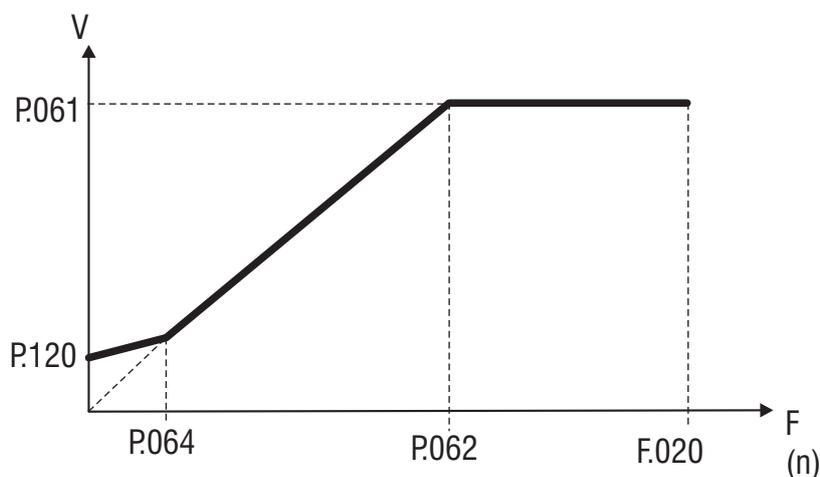
**Figura 1.1-12:** Boost di tensione manuale
