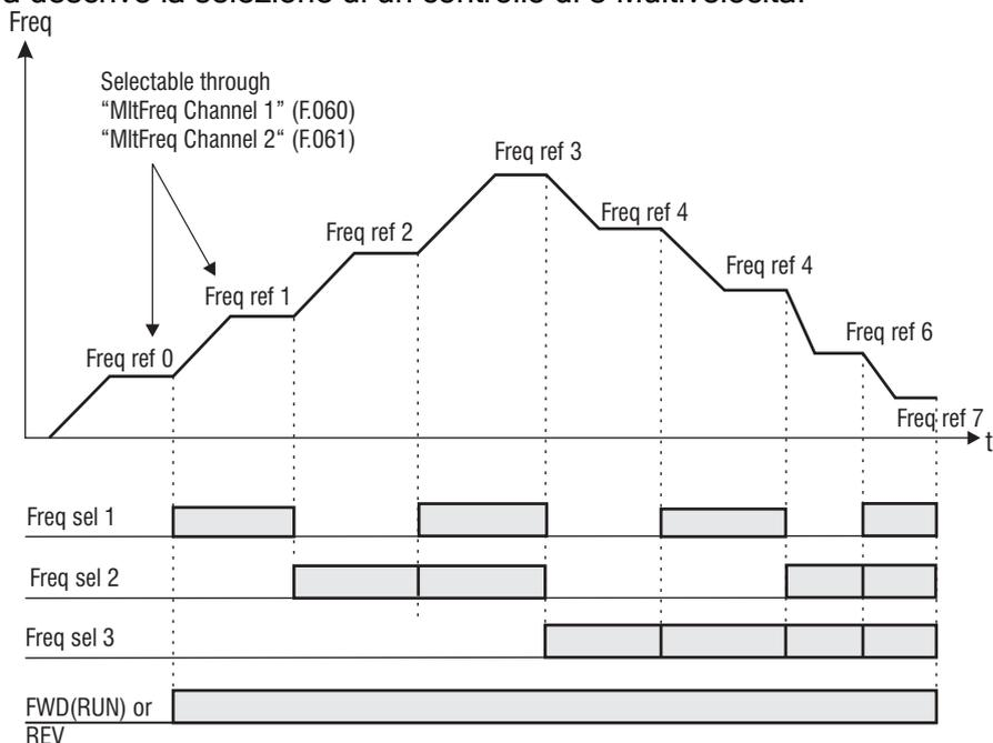
Figura 1.1-3: Multivelocità
