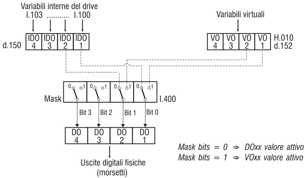
Figura 1.1-6: Configurazione uscite digitali virtuali
