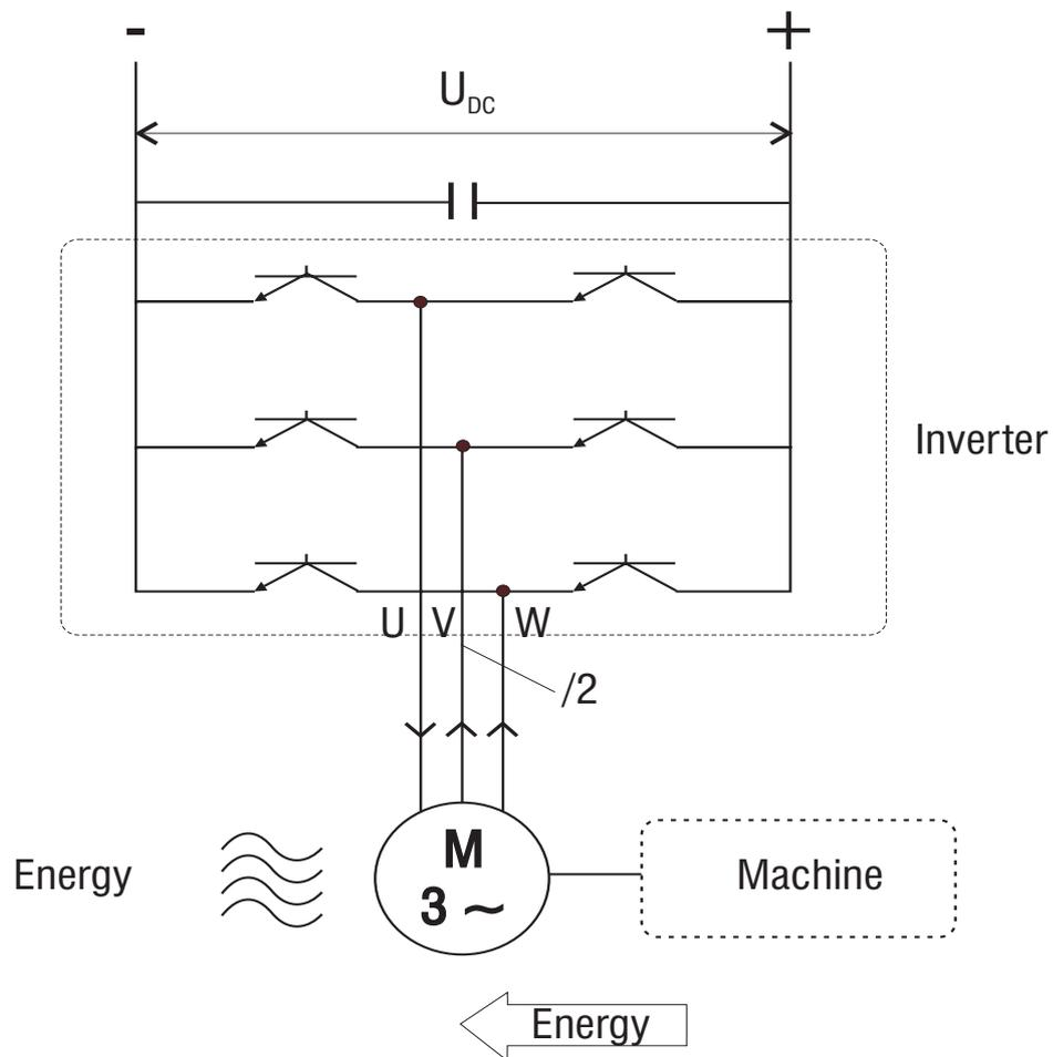
Figura 5.8-1: Frenatura in corrente continua, schema di principio
