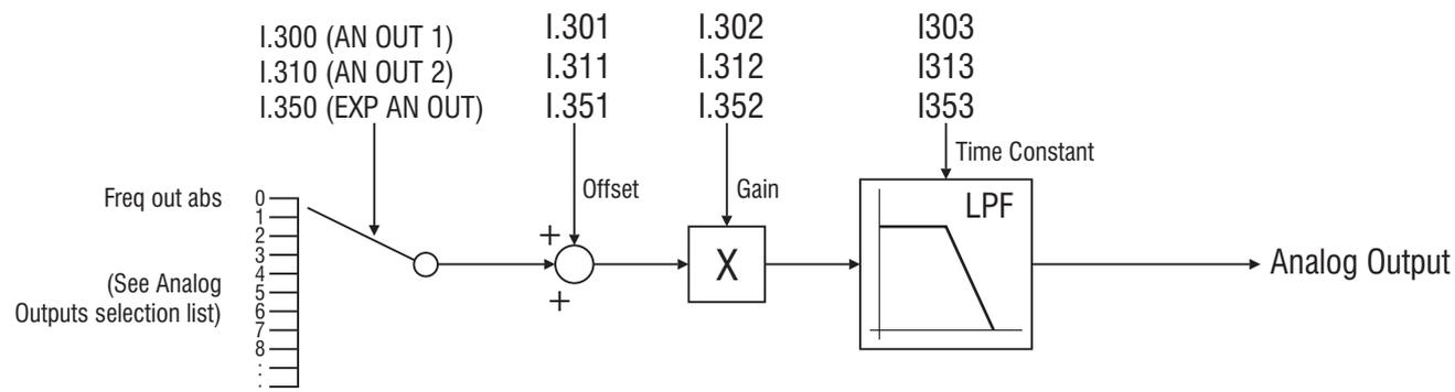
Figura 1.1-3: Uscite Analogiche
