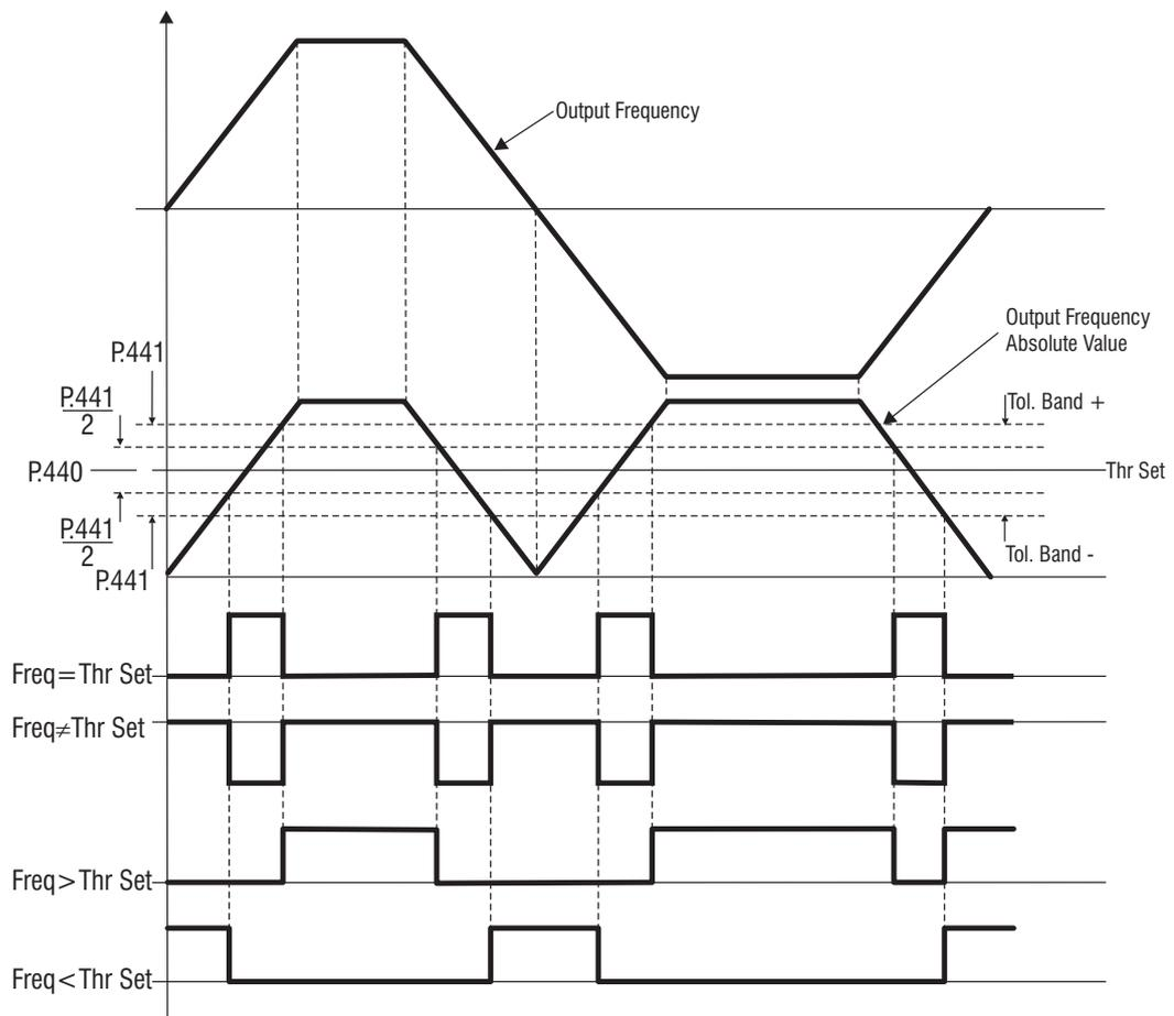
Figura 1.1-21: Soglie di frequenza programmabili (esempio per P.440 e P.441)
