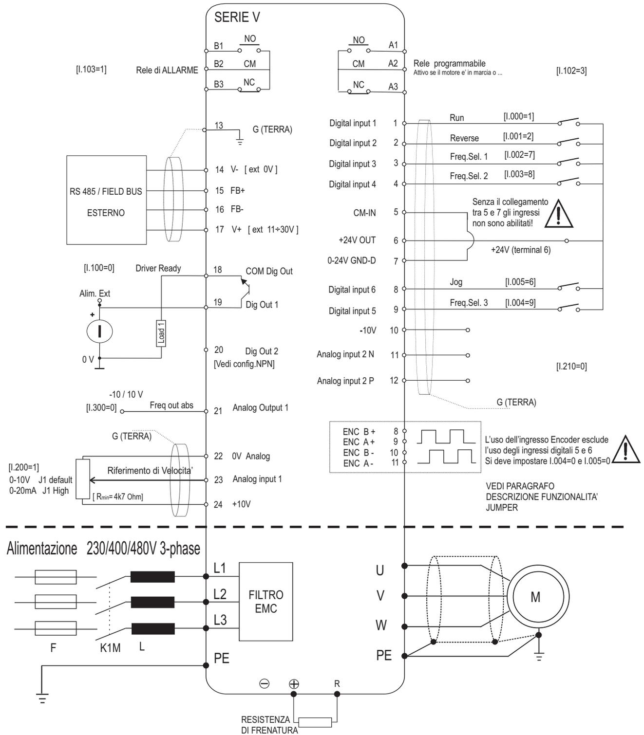
Figura 5.4.1.2: Schema per comandi NPN: Abilitazione ingressi con livello basso
