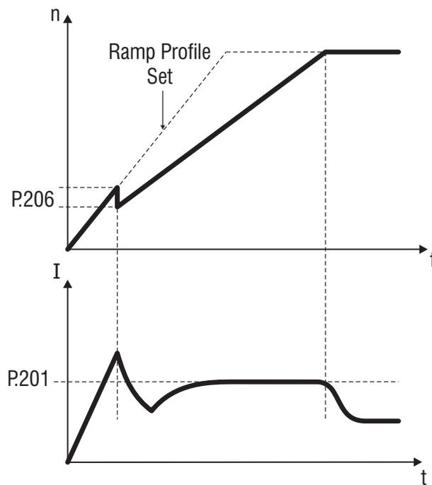
**Figura 1.1-13: Controllo del Limite di Corrente durante la rampa**
