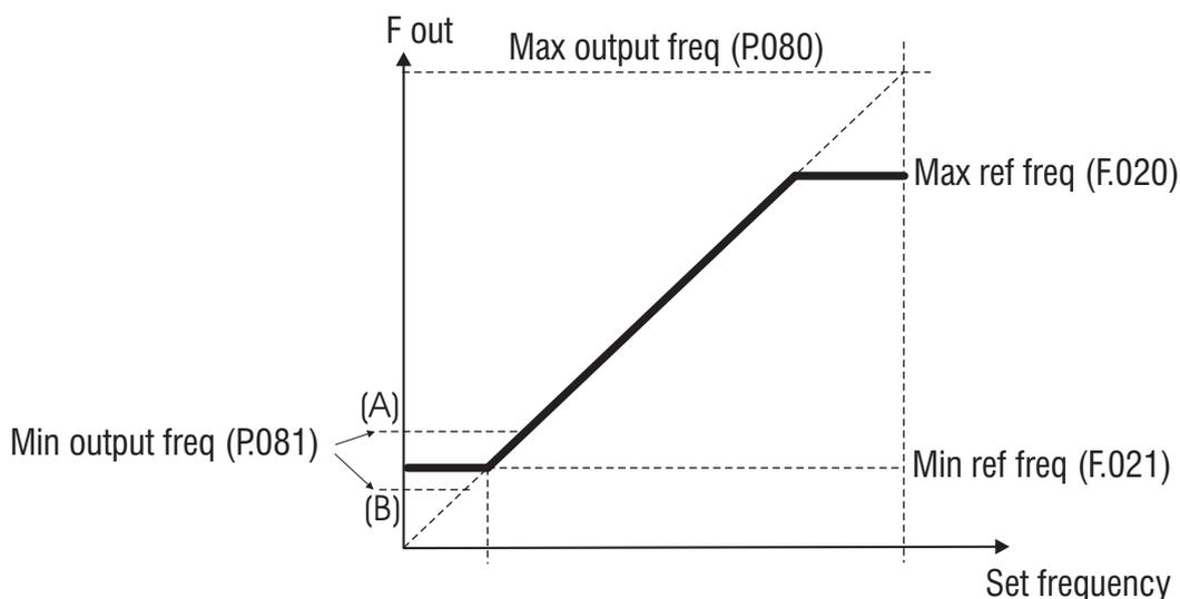
Figura 1.1-2: Min & Max Frequenza di riferimento
