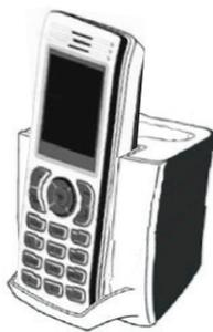
Inserire la presa del caricabatterie e porre il telefono nel supporto di carica. Il led del carica batteria si illumina. Il led di batteria è in modalità di carica sulla schermata del telefono. Se la batteria è completamente scarica, è necessario un tempo di ricarica di diversi minuti prima che l'apparecchio si accenda nuovamente.
