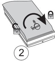
Mantenendo fermo il modulo della batteria, far scorrere il dispositivo di chiusura nella posizione di blocco
