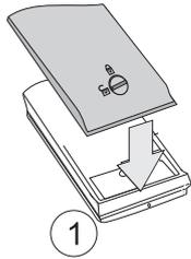
Prima di inserire il modulo della batteria nel telefono, accertarsi che il dispositivo di chiusura sia sbloccato
