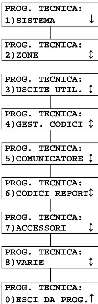
Notare la freccia rivolta verso il basso nella parte inferiore destra del display. Questa freccia indica che dopo il menu **1) SISTEMA**, ci sono altri menu che seguono.
