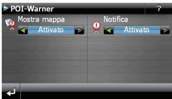
L'avvertimento acustico viene emesso ca. 15 secondi prima del raggiungimento di un punto di monitoraggio del traffico. 7 secondi prima viene emesso un nuovo segnale acustico, questa volta doppio. Un segnale quadruplo indica una velocità troppo elevata. Inoltre, una barra di avvicinamento indica la distanza rispetto al punto di monitoraggio. Esempio di visualizzazione in caso sia attivata la segnalazione sulla mappa.
