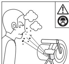
Lancio di materiale e polvere verso gli occhi ed il corpo dell'operatore. Indossate occhiali di protezione, maschera anti-polvere e abbigliamento robusto.
