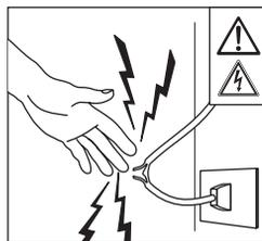
Rischio di scossa elettrica con pericolo di morte. Non toccate le parti in tensione elettrica e mantenete una distanza di sicurezza. Prima di ogni manutenzione scollegate la spina dalla presa di alimentazione.
