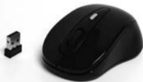
Mouse ottico (con trasmettitore al suo interno)
