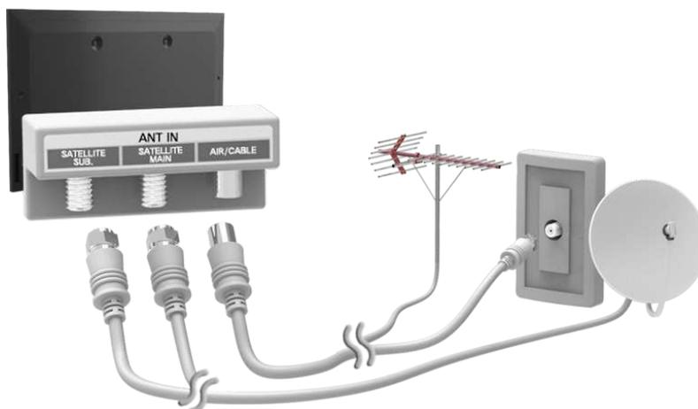
Si consiglia di collegare entrambi i connettori mediante Multi-Switch, Diseqc. Switch o altro e di impostare **Tipologia connessione antenna** su **Doppio**.
