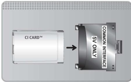
Per la visione di canali a pagamento è necessario inserire una "SCHEDA CI o CI+".
