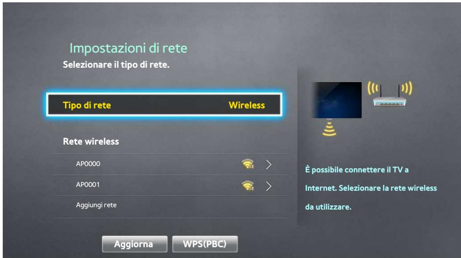
2. Selezionare la rete (SSID) alla quale si desidera collegarsi. Se il router wireless non compare in elenco, selezionare **Aggiungi rete** e digitare l'SSID di rete manualmente.
