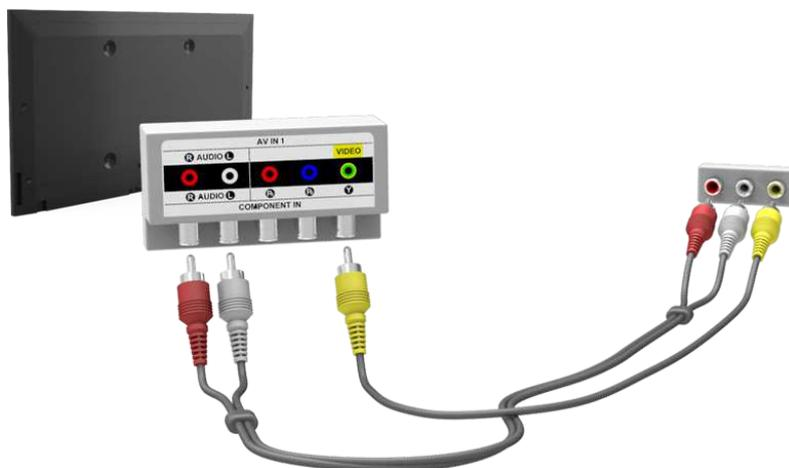
Al termine della connessione, selezionare il dispositivo esterno collegato premendo il tasto **SOURCE**.
