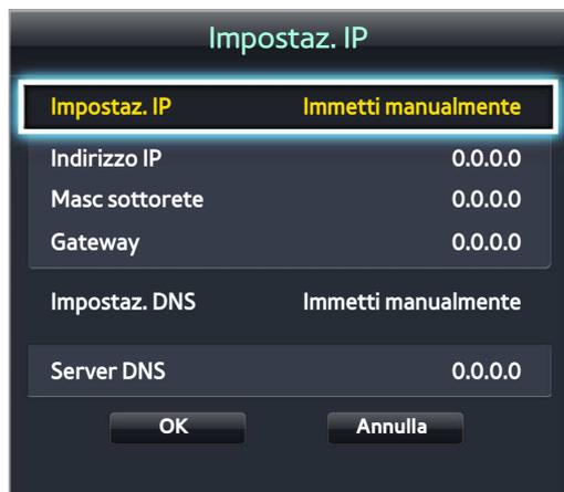
6. Il televisore tenta nuovamente di collegarsi alla rete utilizzando le impostazioni specificate. Una volta stabilita la connessione viene visualizzato un messaggio di conferma. Selezionare **OK**.
