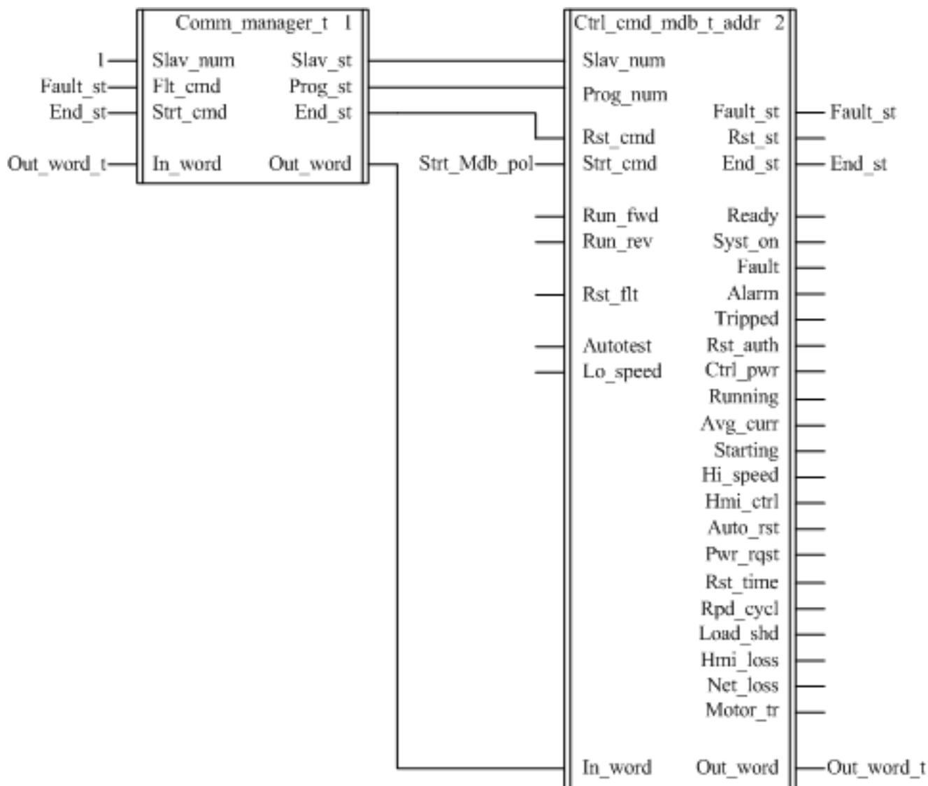
Il DFB Comm\_manager\_t si può usare solo in presenza di controller avviatore TeSys U e sistemi di gestione motore TeSys T sulla stessa rete Modbus SL.
