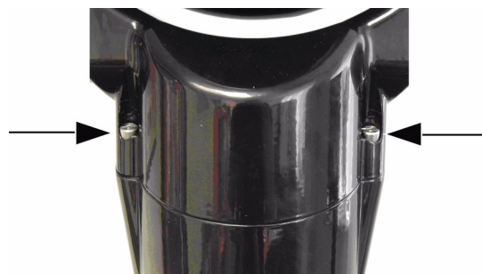
Immagine 5.4 Viti di fissaggio del corpo panoramica
