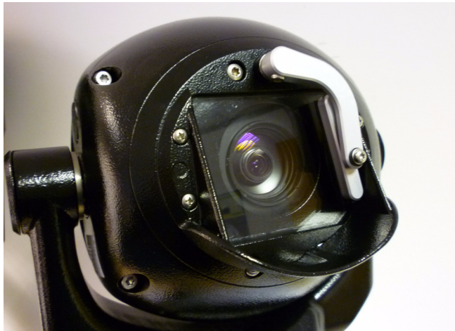
Immagine 5.8 Schermatura per la pioggia capovolta
