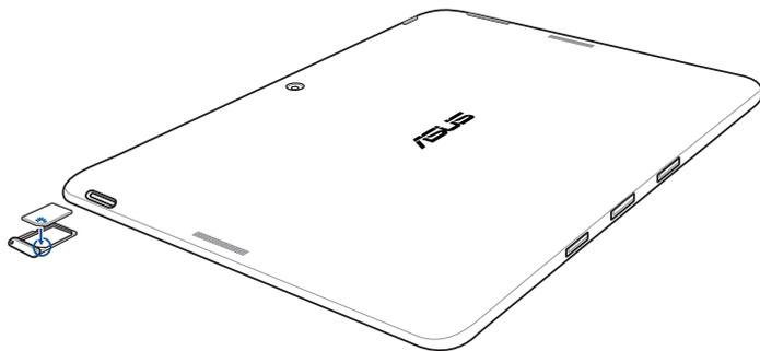
3. Allineate ed inserite il vassoio della Micro-SIM all'interno del suo alloggiamento.
