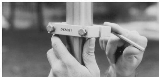
Fissare il sensore al collare avvitando i due bulloni indicati in figura.
