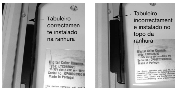
Figura 4: Deslize do tabuleiro da câmara/objectiva para a ranhura
