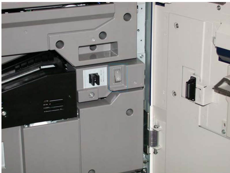
Figura 1. Interruttore principale (dietro allo sportello centrale frontale)
