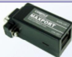
aggiornabile via FTP e seriale; protocolli di trasmissione supportati TCP/IP, UDP/IP, ARP, ICMP, SNMP, FTP, Telnet, DHCP, BOOTP, HTTP e AutoIP; interfaccia seriale CMOS (asincrona), RS-422 e RS-485, 300 ÷ 921,600 bps; trasmissione dati 7 e 8 bit; segnali di controllo DTR/DCD, CTS, RTS; I/O programmabili (3 pin); dimensioni 33,9 x 16,25 x 13,5 mm; peso 9,6 g; alimentazione 3,3 Vdc.
