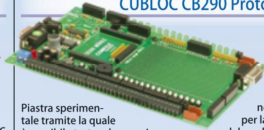
Piastra sperimentale tramite la quale è possibile testare le proprie applicazioni basate sul modulo CUBLOC CB290 senza dover realizzare un apposito circuito stampato. La scheda è provvista della sezione di alimentazione, 16
