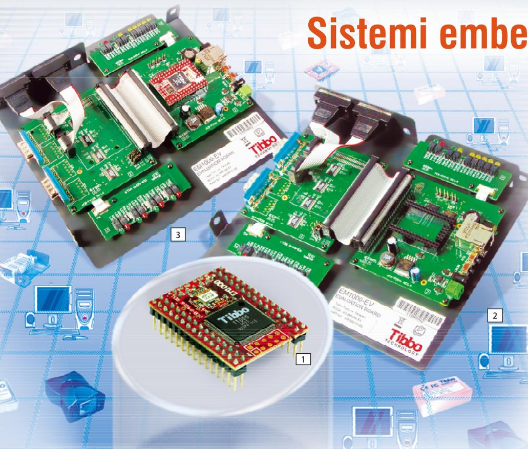
per il controllo del buzzer; memoria Flash da 512 kByte; 64 kByte sono occupati dal firmware (TiOS); 2 kByte di memoria EEPROM Real Time Counter (RTC); PLL (Phase Locked Loop) per il controllo della frequenza di clock del dispositivo; PLL off 11,0592 MHz, PLL on 88,4736 MHz; affidabile Power-On/Brown-out circuito di reset che rende superfluo l'impiego di una rete di reset esterna.
