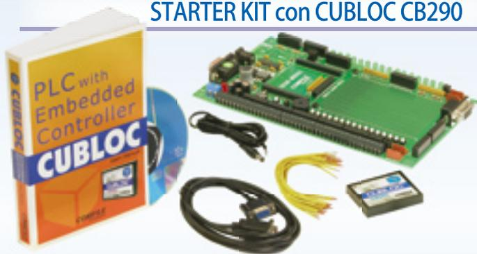
Sistema di sviluppo per moduli Cubloc CB290. Questo programmatore/demoboard permette di imparare ad utilizzare facilmente i moduli Cubloc e di avere a disposizione varie unità periferiche quali LED, interruttori, pulsanti, una piastra sperimentale, un buzzer e altro. Il programmatore/demoboard
