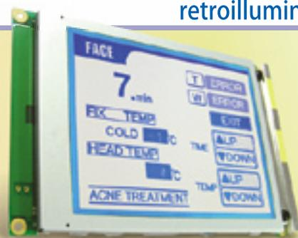
rates 2400 ~ 115.200; interfacce supportate I2C, RS232C (12 V) e RS232 (5V); strati separati per testo
