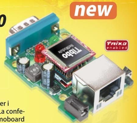
Scheda di valutazione per i moduli EM1202 Tibbo. La confezione comprende la demoboard (EM1202-EV) completa di 1 modulo EM1202, 1 cavo con connettore seriale DB9 M/F, 1 cavo con connettore seriale DB9 F/F, 1 cavo UTP schermato con connettori
