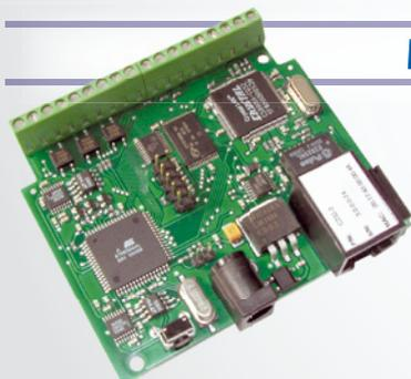
Device Server che consente di collegare dispositivi dotati di porta RS485 e RS232 ad una rete LAN. È dotata di interfaccia Ethernet 10-BaseT (RJ45) e di due porte seriali (connettori a morsetto) utilizzabili sia come RS232 (RX, TX e GND) che come RS485 (A e
