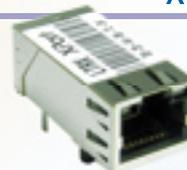
Compatto modulo di conversione Ethernet/Seriale integrato in un connettore RJ45. Rappresenta una soluzione compatta per abilitare qualsiasi dispositivo seriale alla comunicazione tramite Internet o LAN. Particolarmente indicato per essere impiegato con i moduli CUBLOC e CUTOUCH. Dispone di due LED bicolore di segnalazione posti sul connettore RJ45 che permettono di monitorare il traffico dati. Porta Ethernet compatibile 10Base-T o 100Base-
