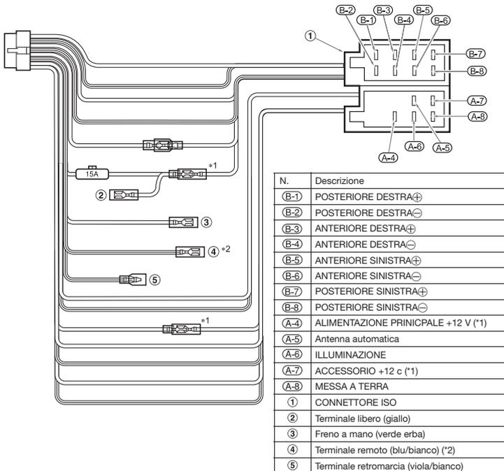
\*1 In alcuni veicoli - **Volkswagen/Opel/Vauxhall** - è necessario scambiare il collegamento dell'accessorio <<Rosso>> e il collegamento <<Giallo>> dell'alimentazione principale per evitare il sovraccarico e la perdita di memoria.
