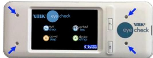
2. Sollevare delicatamente la copertura posteriore dalla parte anteriore del dispositivo Eye Check, cominciando dalla scanalatura all'estremità di destra dell'alloggiamento.
