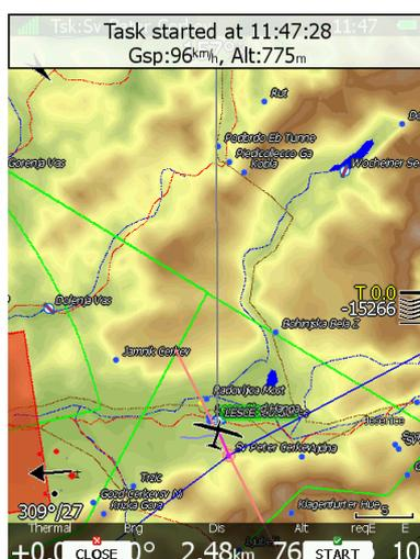
Nel messaggio saranno visualizzate ,velocità al suolo e altitudine. Verranno inoltre visualizzati due pulsanti **CHIUDI** e **START**.
