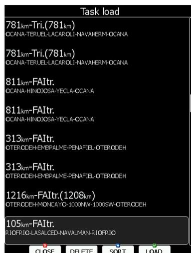
Per ogni prova memorizzata, verranno salvate: la distanza totale della prova, la descrizione e i punti di virata . Selezionare la prova desiderata mediante la manopola in basso a destra e premere **LOAD**. La prova verr  caricata nel file attivo dei piloni. E' anche possibile cancellare la prova dal file attivo.
