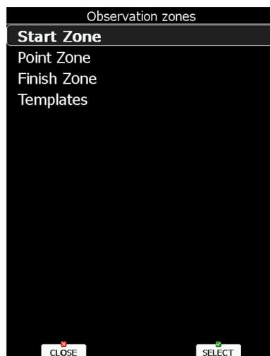
Ogni tipo di zona di osservazione è definita con due angoli, due raggi e una direzione. Usando questi parametri si possono creare separatamente tutte le geometrie conosciute, per la partenza, per l'aggiramento di un pilone e per l'arrivo. Tutte i temi di gara memorizzati nello strumento avranno questa impostazione globale, ad eccezione di quelli modificati dal menù modifica (vedi capitolo **Napaka! Vira sklicevanja ni bilo mogoče najti.**).
