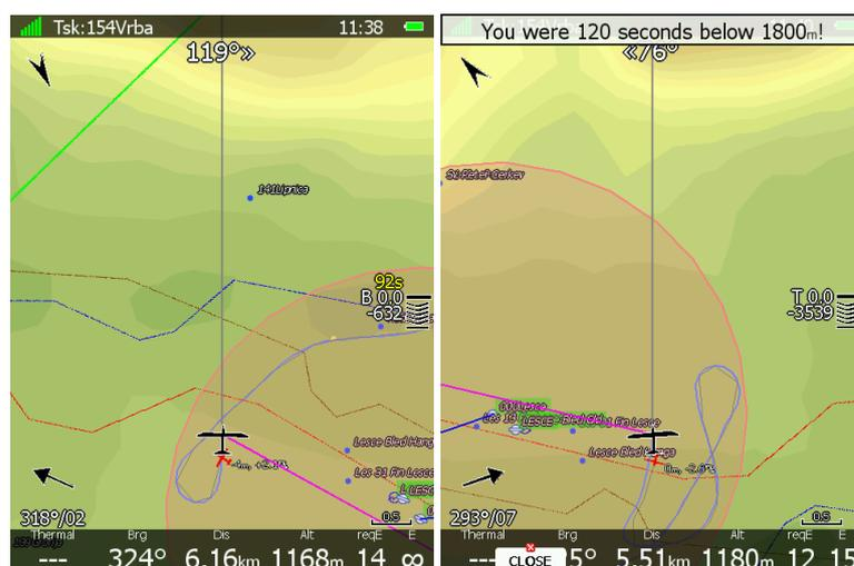
Il numero inferiore indica la differenza dalla quota di partenza. Negativo, indica valori al di sotto della altitudine impostata. Il numero sopra giallo indica in secondi, il tempo da rimanere al di sotto della quota selezionata. Le frecce indicano i metri al di sotto o al di sopra dell'altitudine impostata. Ogni linea rappresenta 10 m. Un messaggio "Sei stato xx secondi al di sotto di yyyy m!." viene mostrato ogni volta che sono soddisfatte le condizioni.
