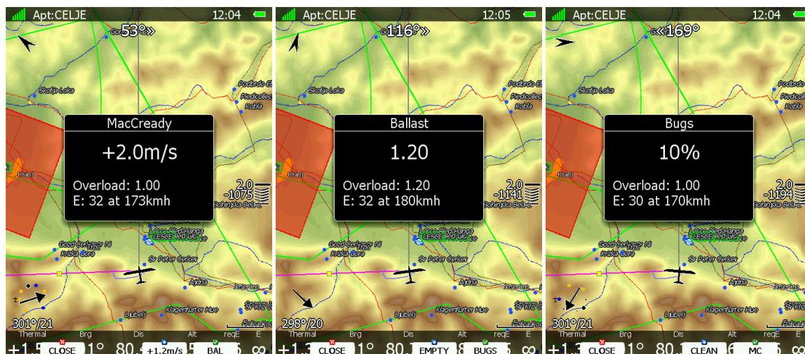
Usare la manopola in basso a destra, per modificare il settaggio del MC. Nell'etichetta di mezzo c'è un suggerimento per l'impostazione basata sulle ultime quattro termiche. In relazione al valore impostato, saranno visualizzati: fattore di carico e massima efficienza con la velocità corrispondente.
