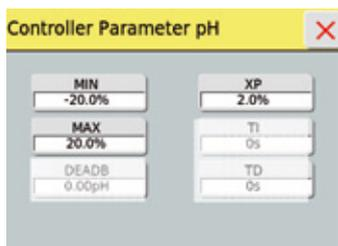
5. Il controllore PID per il pH della configurazione è preconfigurato con parametri standard per soluzioni tampone ( $\pm 1$  pH da pKa) con un Xp del 2 %. Inserire i parametri di processi corretti sullo schermo di DCU.
