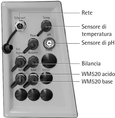
1. Collegare il cavo di segnale WM 520/R2 all'attacco corrispondente del pannello di connessione. Se è necessario correggere il pH con della base, collegare il cavo alla presa jack "Base". Per una correzione dell'acido, collegarlo alla presa jack "Acid".
