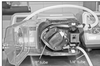
4. Per il tubo da 1/8" installare la pompa nella posizione 1, per quello da 1/4" installarla nella posizione 2. Installare l'elemento richiesto del dispositivo di trasferimento (titolazione) nella porta WM 520.
