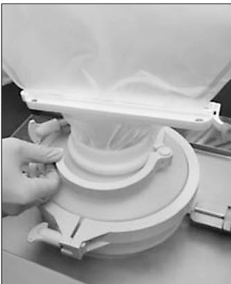
1. Riempire la sacca Flexel® per Magnetic Mixer con acqua di iniezione fino all'80 - 95% del volume finale. Aprire la porta superiore da 8" ed inserire la porta superiore nel supporto del clamp in acciaio inox. Si rimanda al manuale della sacca Flexel® per Magnetic Mixer per quanto riguarda il riempimento della sacca e alle istruzioni per la preparazione della soluzione tampone.
