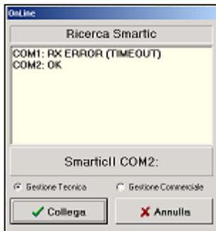
Premendo il tasto COLLEGA SMARTIC, in modo del tutto automatico, vengono testate le porte seriali del personal computer, alla ricerca di una spina SmartIC collegata. In questo caso è stata trovata una spina SmartIC II sulla porta seriale COM2.
