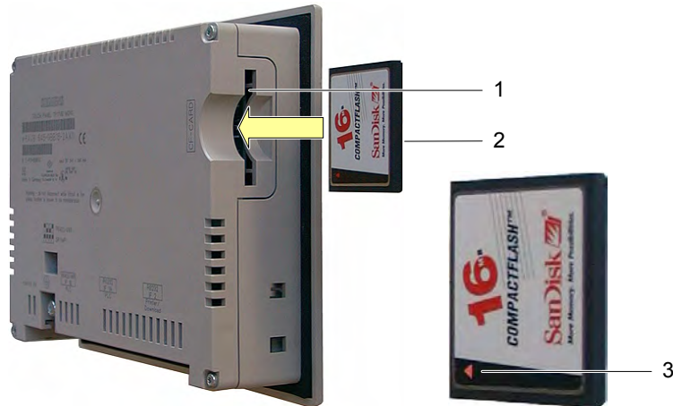
Figura 5-2 Inserimento della scheda di memoria nel pannello TP 170B
