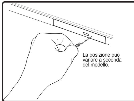
L'espulsione di emergenza è localizzata in un foro sul lettore ottico e viene utilizzata per espellere il cassetto del lettore ottico nel caso in cui l'espulsione elettrica non dovesse funzionare. Non utilizzare l'espulsione di emergenza al posto dell'espulsione elettronica. **NOTA: Assicurarsi di non danneggiare l'indicatore di attività situato nella stessa zona.**
