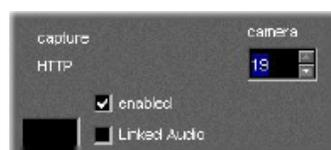
Una volta specificati l'indirizzo IP e la Request String, va abilitata la telecamera e allocata della memoria. Per prima cosa va abilitata (enabled) la telecamera come mostrato a fianco
