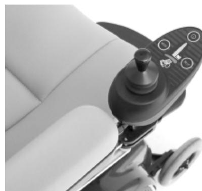
Figura 19. Joystick girevole (posizionato in avanti)
