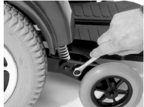
Figura 30. Regolazione delle rotelle anti-ribaltamento
