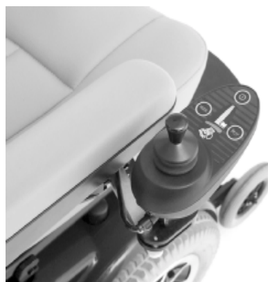
Figura 20. Joystick girevole (riposto all'indietro/di lato)
