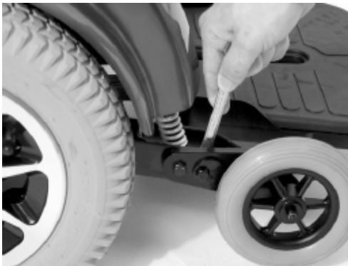
Figura 29. Regolazione delle rotelle anti-ribaltamento
