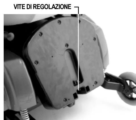
Figura 22. Inclinazione della pedalina
