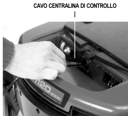
Figura 11. Connessione del cavo della centralina di controllo
