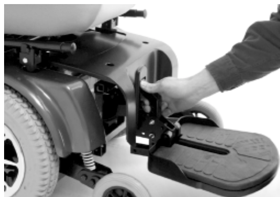
Figura 32. Rimozione del telaio pedalina
