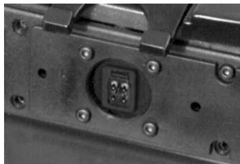
Figura 5. Morsetto centralina di controllo Europa Remote
