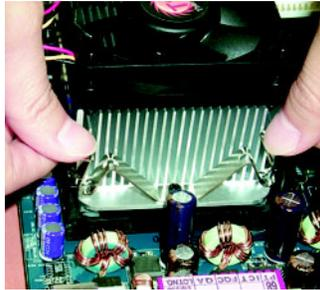
1. Per prima cosa agganciare un'estremità del supporto del dissipatore di calore alla presa CPU.
