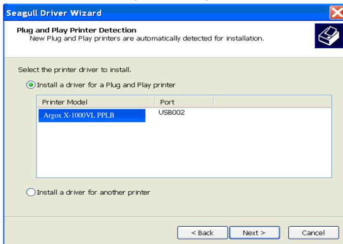
7. Selezionare modello ed emulazione: X-1000VL PPLB o X-2000V PPLB
