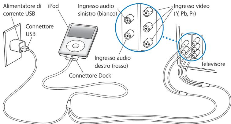
**Nota:** le porte del televisore o del ricevitore possono essere diverse da quelle riportate in figura.
