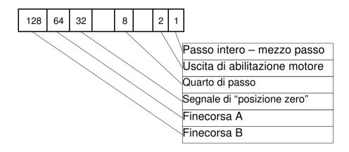
Se il motore è disabilitato ed i finecorsa sono inattivi, il risultato sarà "0".
