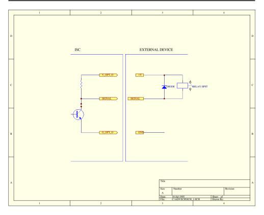
I segnali di ingresso/uscita XP1, XP2, XP3, XP4, XP5 sono opto-isolati e, tramite i ponticelli di personalizzazione, sono utilizzabili come ingressi o come uscite. Il segnale di riferimento di massa è G\_OPT\_X presente sul pin 20C (ISC-0x-R-x2) o sul pin A10 (ISC-0x-D-x2) il segnale di alimentazione per le resistenze di pull-up è V\_OPT\_X presente sul pin 32C (ISC-0x-R-x2) o sul pin A16 (ISC-0x-D-x2).
