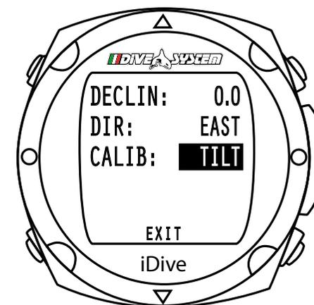
A questo punto prendere in mano l'orologio e ruotarlo sull'asse longitudinale fino a quando non compare il segnale OK.
