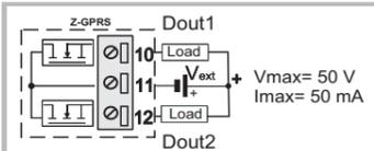
Lo stato delle uscite è impostabile da registro Modbus. I bit del registro rappresenteranno rispettivamente lo stato delle due uscite. Vedere **MANUALE UTENTE**. Ai morsetti di uscita possono essere collegati carichi di tipo resistivo, induttivo o capacitivo.
