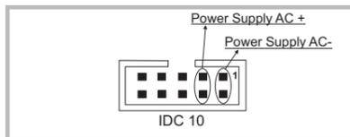
In figura si riporta il significato dei vari pin del connettore IDC10 nel caso in cui si desideri fornire i segnali direttamente tramite esso.
