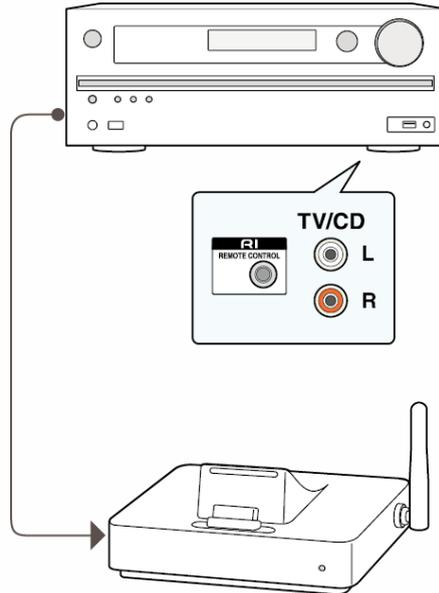
Collegare un componente Onkyo con un jack RI a questa unità utilizzando un cavo RI e un cavo audio analogico. Per i dettagli, fare riferimento al manuale di istruzioni del componente con jack RI. Il cavo RI può essere collegato in qualsiasi ordine. Quando ci sono due jack RI, entrambi i jack funzionano allo stesso modo e sono intercambiabili.
