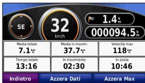
Il computer di viaggio indica la velocità corrente e fornisce informazioni utili sul viaggio. Per visualizzare il computer di viaggio, toccare il campo **Velocità** sulla mappa.
