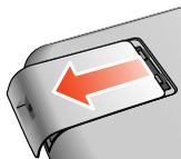
2. Inserire la scheda TV digitale nell'alloggio (1), poi premere per bloccare la scheda in posizione (2).
