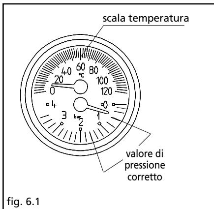
AccertateVi all'inizio della stagione di riscaldamento e di tanto in tanto durante l'utilizzo, che il termoidrometro abbia valori di pressione ad impianto freddo, compresi tra 0,6 e 1,5 bar (scala in colore azzurro), ciò evita rumorosità dell'impianto dovuta a presenza d'aria.
