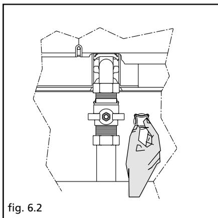
Nel caso ciò avvenisse a causa di perdite nell'impianto o di spurghi d'aria ripetuti, si deve ripristinare la pressione aprendo per il tempo necessario il rubinetto di riempimento posto sotto la caldaia (fig. 6.2) e controllare la pressione indicata dal termoidrometro.
