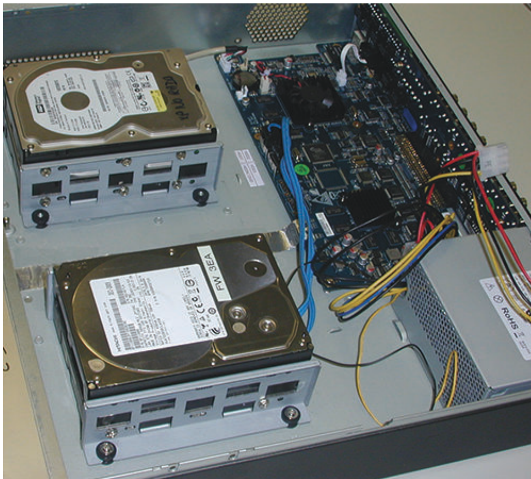
Figura 5.10: Installazione dei dischi rigidi 3 e 4
