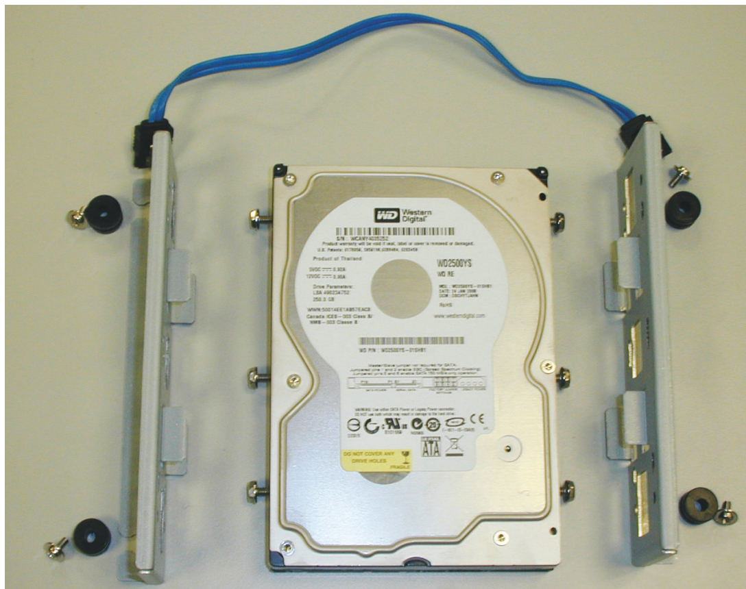
Figura 5.7: Componenti di installazione del disco rigido (unità DIVAR 5000)
