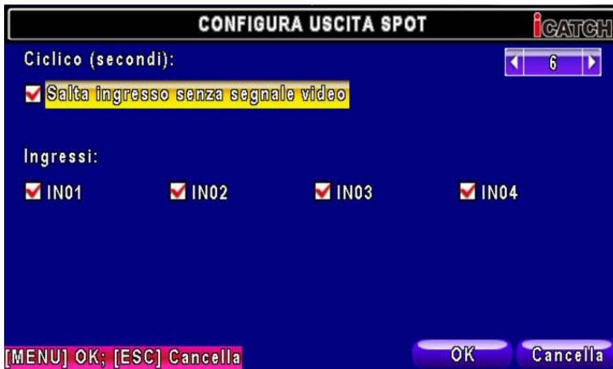
Il presente DVR ha due diverse modalità di uscita del segnale video una Principale (Main), dove è possibile visualizzare tutto (menu ed ingressi) e l'altra è l'uscita Spot. L'uscita Spot non permette la visualizzazione del menu ma può essere configurata per avere una singola immagine oppure una scansione ciclica delle immagini o la visualizzazione della immagini collegate ad un evento.
