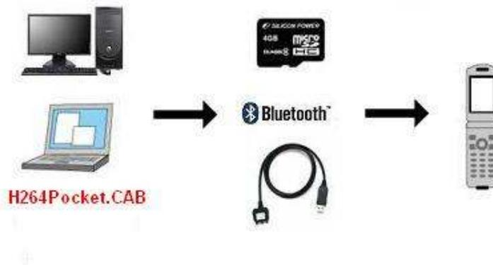
Passo 2: Installare l'applicativo "H264Pocket.CAB" nel telefono, saranno create due cartelle "H264Pocket". Questo sarà installato automaticamente dopo averlo caricato sul telefono; altrimenti selezionarlo per l'installazione.
