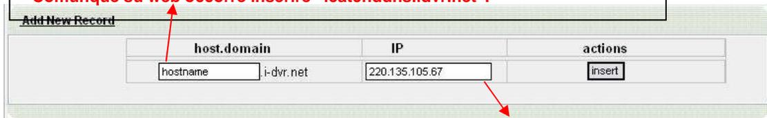
**Il sistema mostrerà l'indirizzo IP del PC da cui viene effettuata la connessione. Se l'indirizzo IP del DVR è conosciuto è possibile inserirlo direttamente in questa colonna. Se non si conosce premere il tasto "Add new".**
