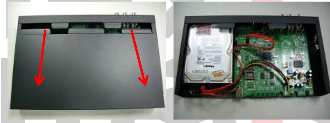
Passo 3) Posizionare lo HDD nella parte sinistra e collegare i cavi di alimentazione e dati.
